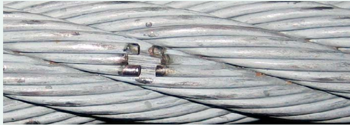
Häufung von Drahtbrüchen – kann sehr gut magnetinduktiv erkannt werden
