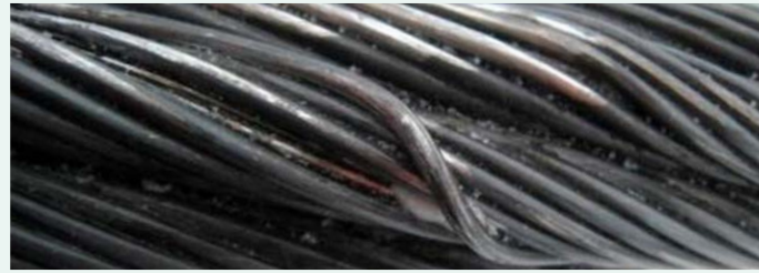
Abstehender Draht, der seine Nachbarn kreuzt [Quelle: IFT Uni Stuttgart]
