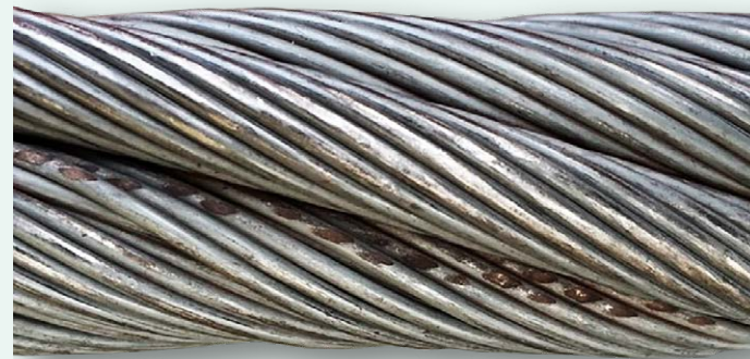
Druckspuren an einem Kreuzknoten nach längerem Betrieb
