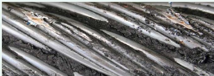
Reibmartensit durch Rutschen einer Klemme – durch Abschleifen können hier Drahtbrüche verhindert werden [Quelle: IFT Uni Stuttgart]
