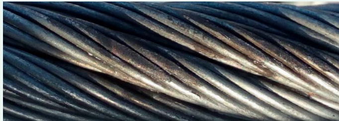
Abrieb auf der Drahtoberfläche – für den Magnet nicht auffindbar
