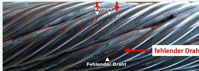
Kerben an der Seiloberfläche, wenn ein Drahtende nicht rechtzeitig entfernt wird [Quelle: IFT Uni Stuttgart]
