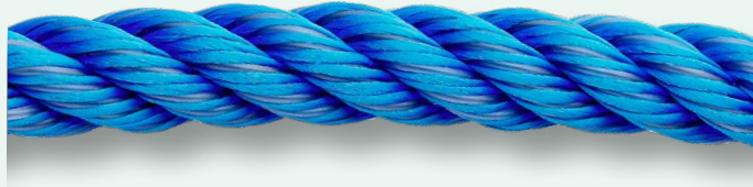
18 mm Schlepliftförderseil aus Kunstfasern im Trossenschlag
