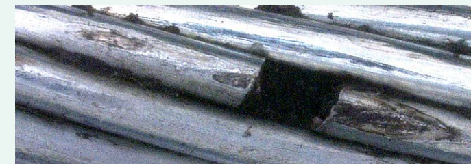
Litzen und Drähte haben an den Berührstellen vor dem Bruch des Drahtes aneinander gerieben
